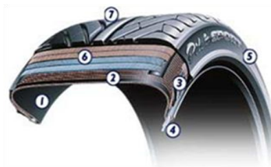
Figure 5: Le pneu, un matériau composite. (Source : document Aliapur)
