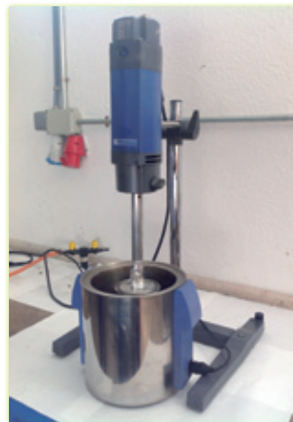
Figure 10. Disposition d'un appareil de laboratoire de base pour la fabrication de bitumes-caoutchouc
