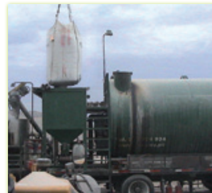
Figure 18. Chargement du caoutchouc dans les trémies de l'unité
