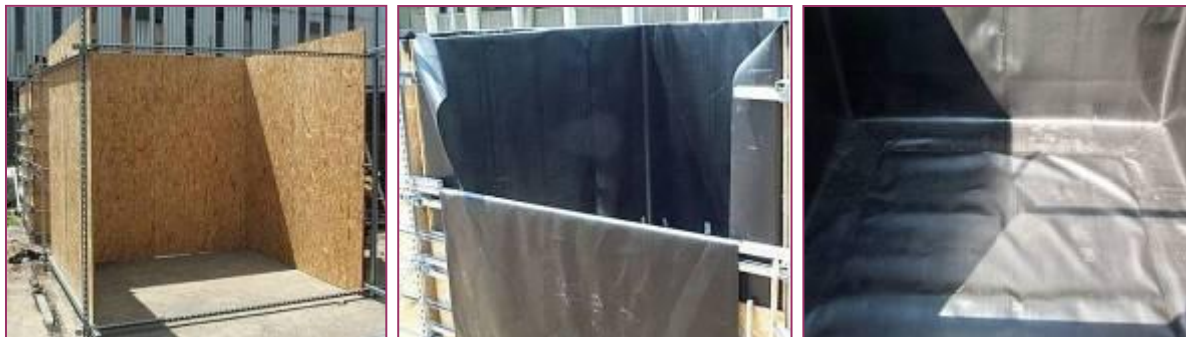
Figure 1 : Vue lors de la confection des casiers lysimétriques
